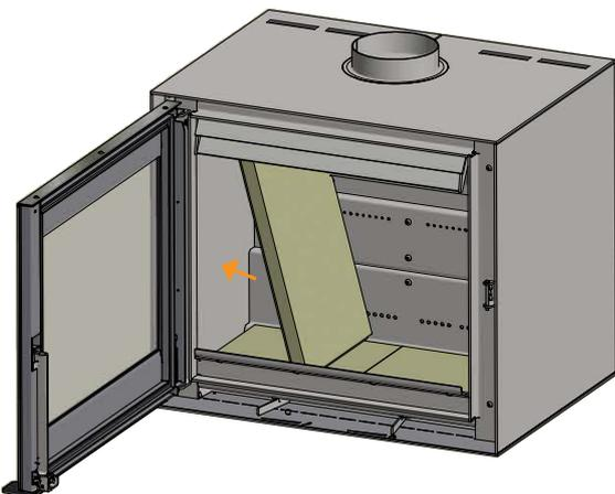
Die linke Rückplatte montieren
