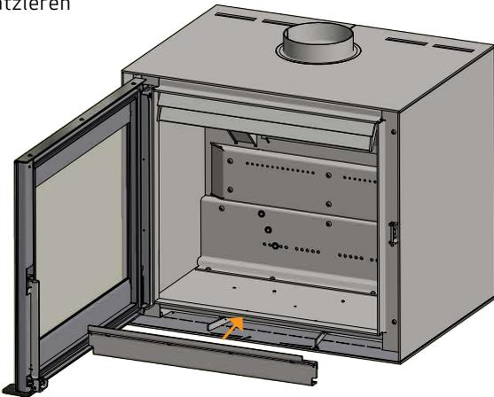
Die Bodenplatten so einsetzen, dass die abgeschrägte Kante nach hinten und abwärts kehrt
