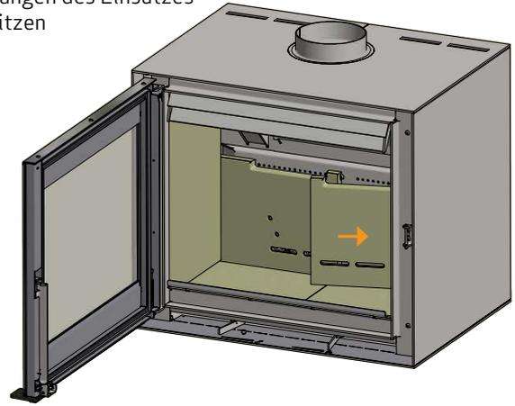
Die untere Rauchumlenkplatte montieren. Die Rauchumlenkplatte muss von den Rückplatten gestützt werden. Die Stifte montieren und die Rauchumlenkplatte einsetzen
