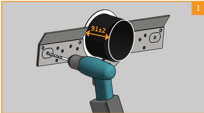
Die Löcher mittels der Bohrschablone bohren
