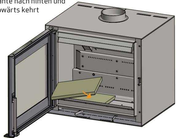
Die linke Brennkommerplatte montieren
