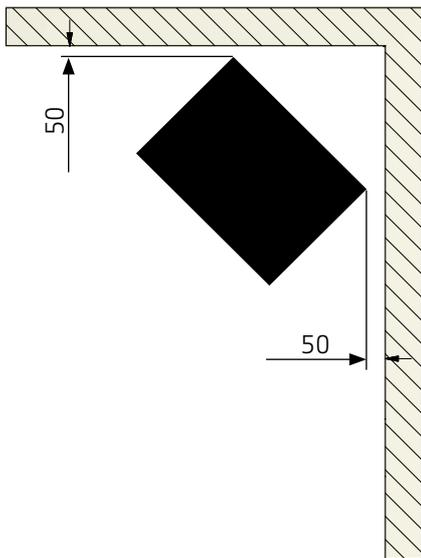
Parallelinstallation an der Rückwand
