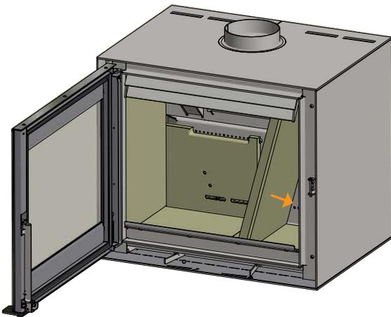
Die rechte Rückplatte montieren. Die hinteren Brennkammerplatten müssen so montiert werden, dass die Öffnungen in den Platten exakt über den Tertiäröffnungen des Einsatzes sitzen
