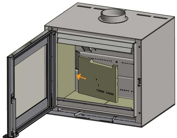
Die rechte Brennkammerplatte montieren
